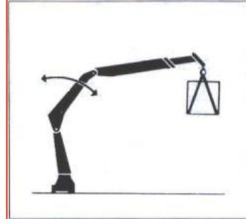
No arrastre o empuje objetos que estén colocados directamente en el suelo, al hacer esto puede provocar graves daños en los engranajes del giro de la grúa.
